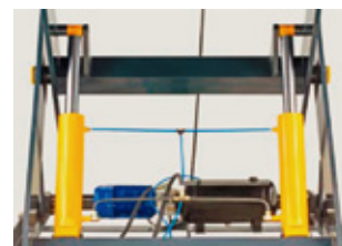
Válvula de seguridad en los cilindros
