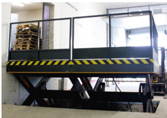
Mesa doble tijera con barandillas laterales y puertas batientes
